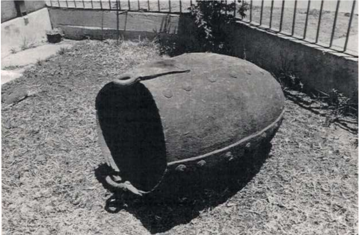
Balde Minero encontrado en el cerro Tamaya. Hecho a mano en 1854 con planchas de fierro
